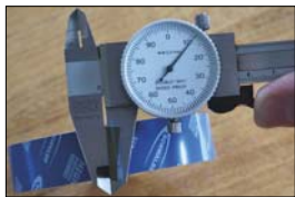
Doba milimetrových pásek do bezdušových ráfků je pryč, moderní pásky od Schwalbe, kterou používá i Remerx, mají tloušťku 0,1 mm a dokonale tak kopírují vnitřní profil ráfku.
