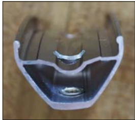
Velký pokrok udělala technologie bezdušových ráfků, které se dnes prosazují výraznou měrou i na silnici. Základní je ovšem správné provedení dvojice „zámků“ mezi středem vnitřní části a patkou ráfku, kde se zajistí patka pláště.
