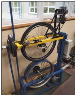
Kolo poháněné přes řetěz elektromotorem se odtáhne na bubnu vybaveném kovovými výstupky, což simuluje nárazy při jízdě. Kolo musí nejen odolat vysokému počtu nárazů, ale opakovaným měřením spotřebovaná energie vůči ujetým kilometrům lze měřit i účinnost kola.
