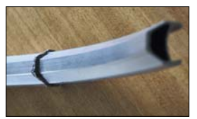
Vývoj roboticky svařovaného spoje není jednoduchá záležitost. Jednak je to náročné na energii, ale také materiál a výrobní postup, aby se stěny ráfku v místě svaru nezortily.
