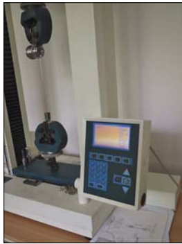
Pro pevnost kol je důležité měřit nejen boční tuhost nebo vertikální odolnost ráfku, ale také pevnost drátů. Speciální trhačí zařízení napíná drát až do krajní meze, dokud nepraskne. Většinou je to pod závitem nebo u hlavičky.
