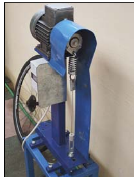
Zařízení s vačkou podrobuje drát napnutý hmotností 200 kg neustálému střídání napětí v počtu půl milionu cyklů.
