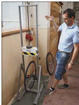
Test vertikální odolnosti kol s ráfků vyššími než 25 mm vyžaduje UCI pro přední kola. Závazí páda jako na gilotině z výšky jednoho metru a nesmí zdeformovat ráfek ani vertikálně, ani jej vyhnout do boku o více jak 1 mm.
